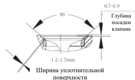
Рис.5: Глубина посадки клапана
